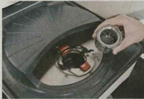
容器を回転させ、鉄球同士を衝突させることで水素をつくる実験装置＝いずれも岐阜市の岐阜薬科大で
